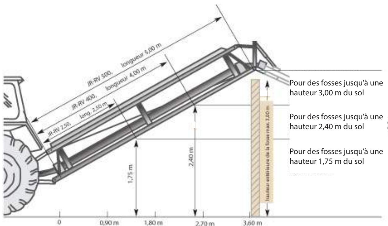
La longueur de la rallonge pour mixeurs dont on a besoin s'adapte à la hauteur de la fosse à lisier. Avec la rallonge de châssis OCELO, on peut malaxer le lisier dans des fosses jusqu'à une hauteur de 3,00 m du sol.
