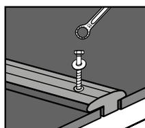
Visser la vis et la rondelle jusqu'à ce qu'elles reposent de façon uniforme. **Ne pas visser à l'extrême !**
