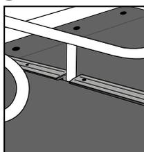
Couper si nécessaire le profil en T et l'emboîter; le cas échéant, placer **des fixations supplémentaires** dans le profil
