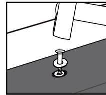
Frapper le clou-vis avec la rondelle jusqu'à ce qu'il repose de façon uniforme et légèrement plus bas que le niveau du tapis
